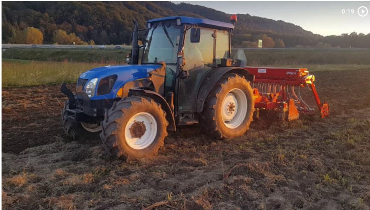
Podrahljavanje z riperjem 30 cm globoko (oblika nogače je zelo pomembna), hitrost največ 5 km/h
